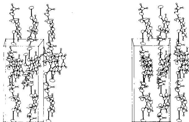
Fig. 3. Vue suivant c de la structure de C 8 H 8 CINOTe.
